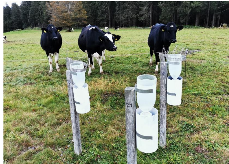
Abb. 34: Depositionsbehälter auf dem Schauinsland vor einer Kuhweide (Foto: R. Hug).
