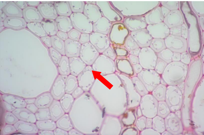
Abb. 28: Löcher in der Zellwand (roter Pfeil) zeigen die starke Zersetzung des Holzgewebes durch den Pilz „Pfennig-Kohlenkruste“ (Foto: J. Grüner).
