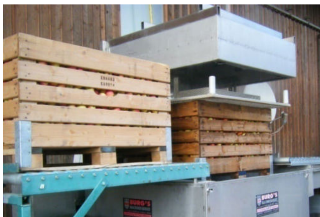
Bild 22: Anlage für Heißwassertauchverfahren. (© Christoph Denzel)
