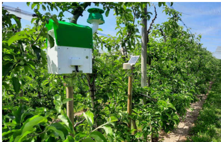
Monitoring mit einer automatischen Pheromonfalle Foto: Jonathan Wenz/LTZ
