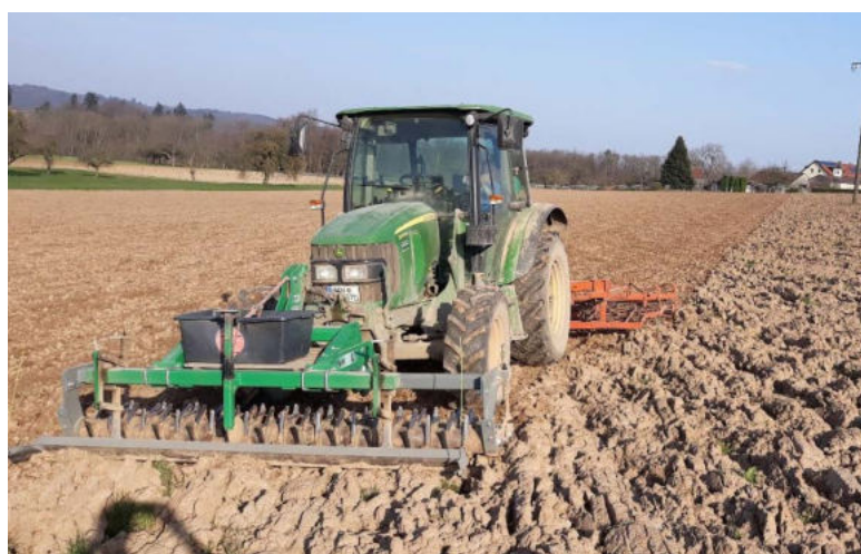
Bild 9: Anlage falsches Saatbett mit Frontpacker für Rückverfestigung und Einebnung sowie Zinkenegge hinten. (© Jonathan Kern)
